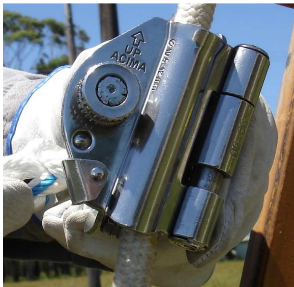
Figura 35 – Fechamento e travamento do trava-quadras
