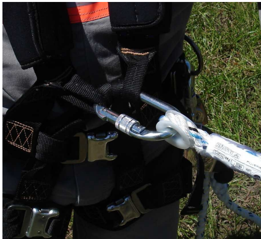
Figura 34 – Instalação do trava-quadras no cinto paraquedista
