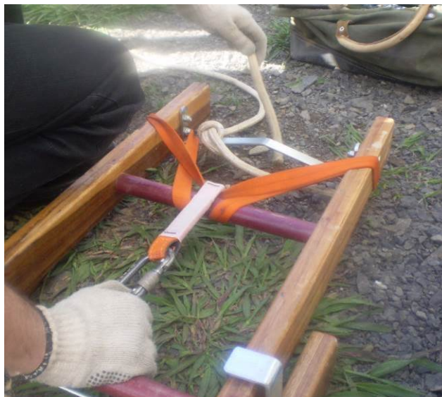
Figura 12 – Instalação do ponto de ancoragem
